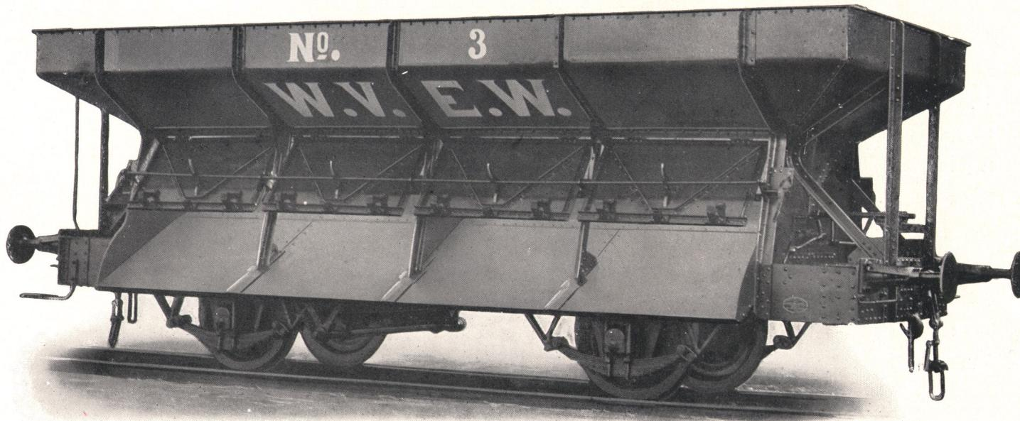
Fig. 9624. Zweiachsiger Seitenentleerer, Bauart B, für 1435 mm Spurweite.
