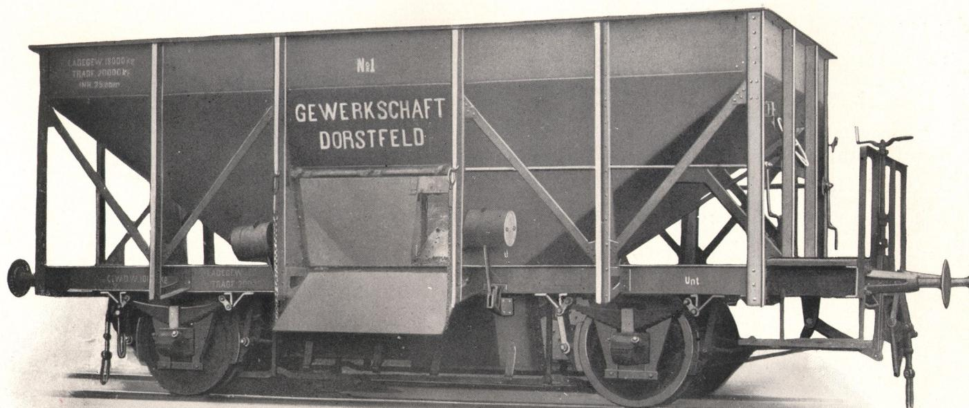
Fig. 9625. Zweiachsiger Selbstentlader, Bauart F, für 1435 mm Spurweite.
