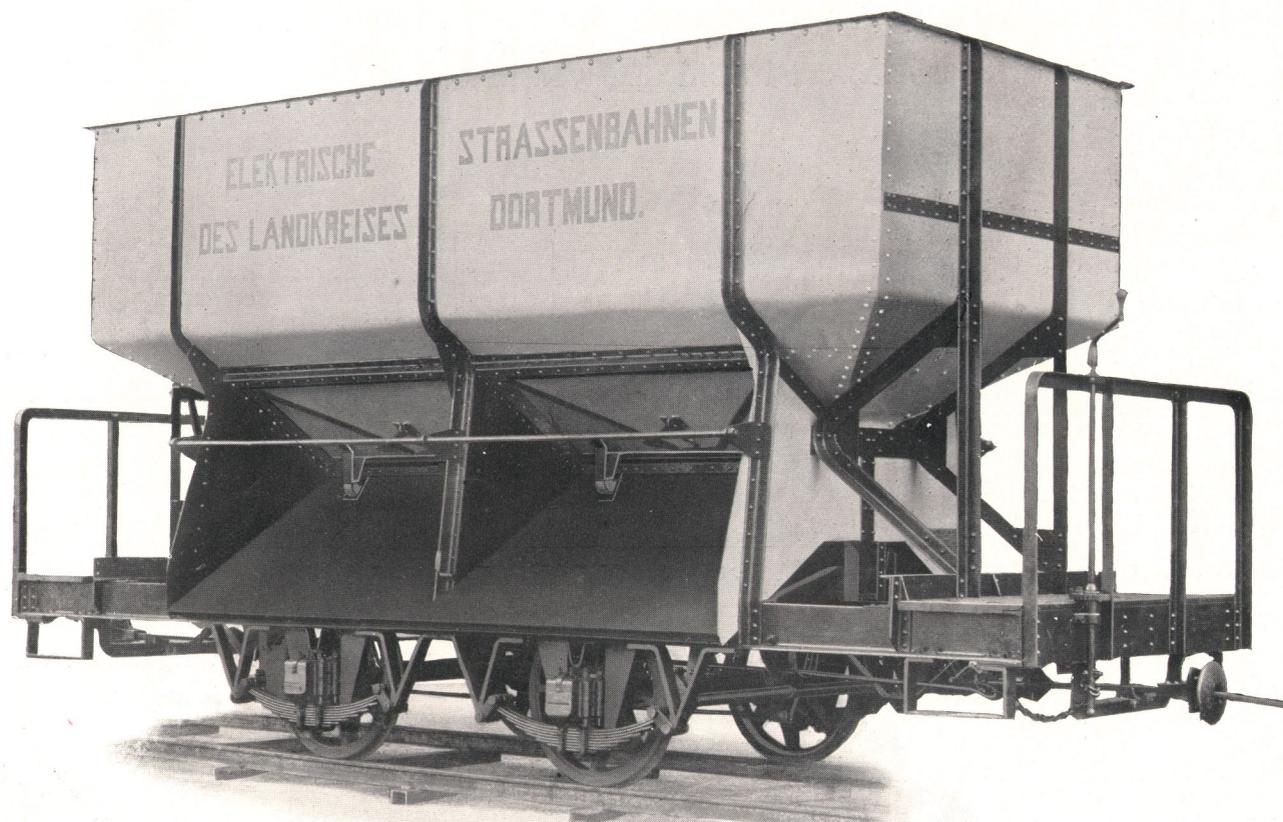
Fig. 9581. Zweiachsiger Seitenentleerer, Bauart B, für 1435 mm Spurweite.
